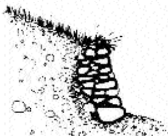
mur de soutènement archaïque
