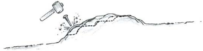
Principe de déroctage vue en coupe
