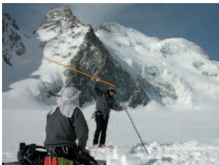
Dans les trous, des perches en bois sont installées. Elles permettront de mesurer l'ablation en fin d'été
