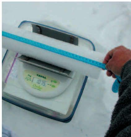
Les carottes sont mesurées et pesées pour obtenir leur équivalence en eau
