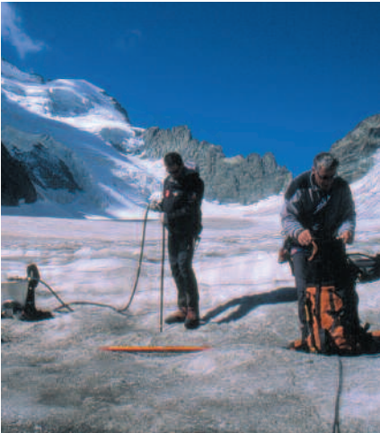
Forage dans la glace avec une sonde thermique
