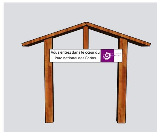
Rappel Figure 46 - Prototype d'arches piétonnes à installer dans le PNE. Réalisation : LM, LB, GD via SketchUp, janvier 2025
