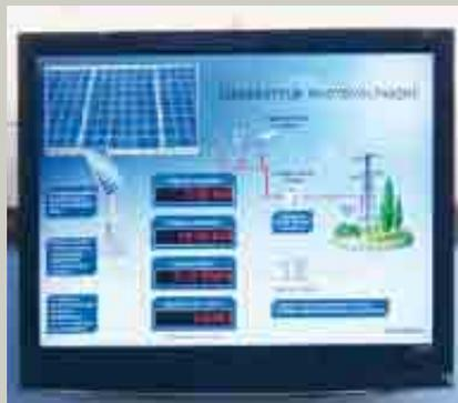
**Le monitoring de l'installation** présente deux intérêts majeurs : surveillance du bon fonctionnement de l'installation avec télémaintenance éventuelle et surveillance de la performance de l'installation
