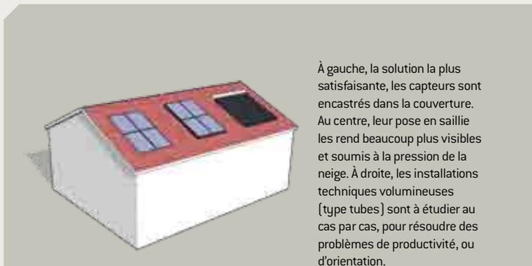
À gauche, la solution la plus satisfaisante, les capteurs sont encastrés dans la couverture. Au centre, leur pose en saillie les rend beaucoup plus visibles et soumis à la pression de la neige. À droite, les installations techniques volumineuses (type tubes) sont à étudier au cas par cas, pour résoudre des problèmes de productivité, ou d'orientation.
