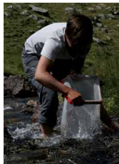
Prélèvement d'invertébrés au filet Surber
