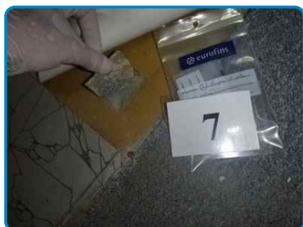
Prélèvement n° 7 : Plancher Ragrée et colle (dans 1er étage Entrée)
