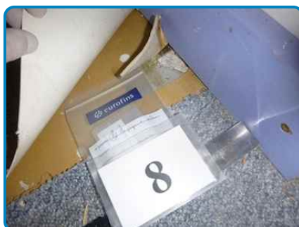
Prélèvement n° 8 : Plancher Ragrée et colle (dans 1er étage Coin cuisine)
