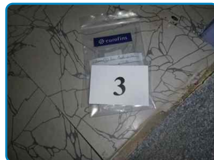
Prélèvement n° 3 : Plancher couche supérieure Revêtement plastique en lé et colle (dans 1er étage Entrée)
